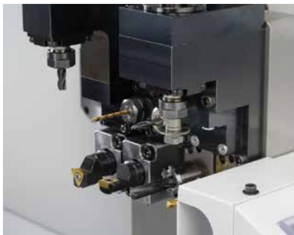
X, XII型の背面刃物台は、上段に回転工具4本、下段に固定工具4本、合計8本の工具を取り付けることができます。
