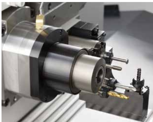
対向刃物台は、オプションでピンチミーリングが行える刃物台や、深穴加工に対応する刃物台も選択できます。
