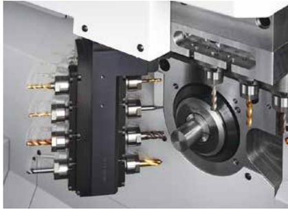
U32B (くし刃回転工具B軸)
